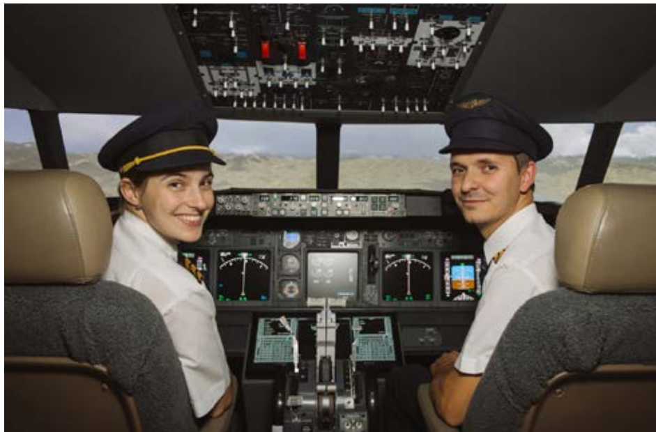
Realistický dojem z používání kokpitu doplňuje výhled zajištěný projekcí na tři plátna, se zorným úhlem téměř 180°. Foto: AirWine
